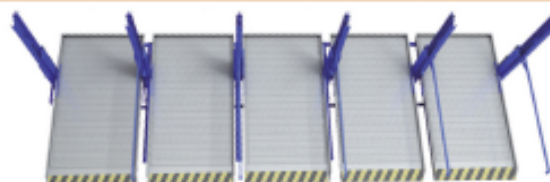
După distribuire: 1 unitate A + 4 unități B, doar 6 stâlpi
